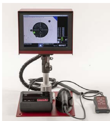
Moniteur tactile et programmable avec imprimante thermo, lecteur code à barrettes (2 D) et télécommande
